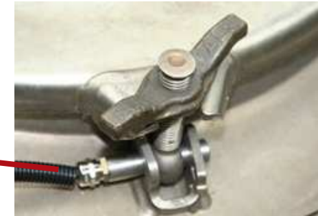
Sensor im Knebel des Domdeckels
